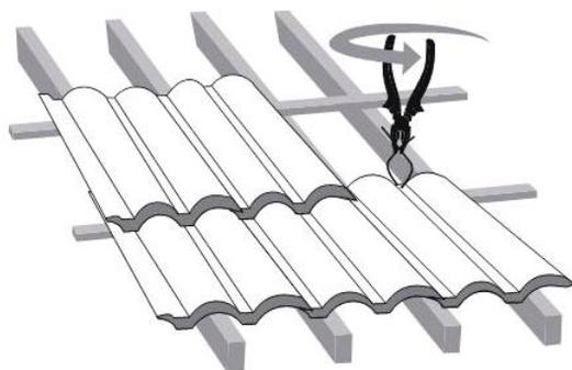
**NOTA:** Quando se tratar de obras com beiral de madeira aparente, é obrigatório o amarre das telhas do beiral com arame galvanizado, utilizando-se do furo existente sobre a telha. Em lugares sujeito a ventos extremamente fortes, recomendamos que se amarre as telhas em fileiras alternadas
